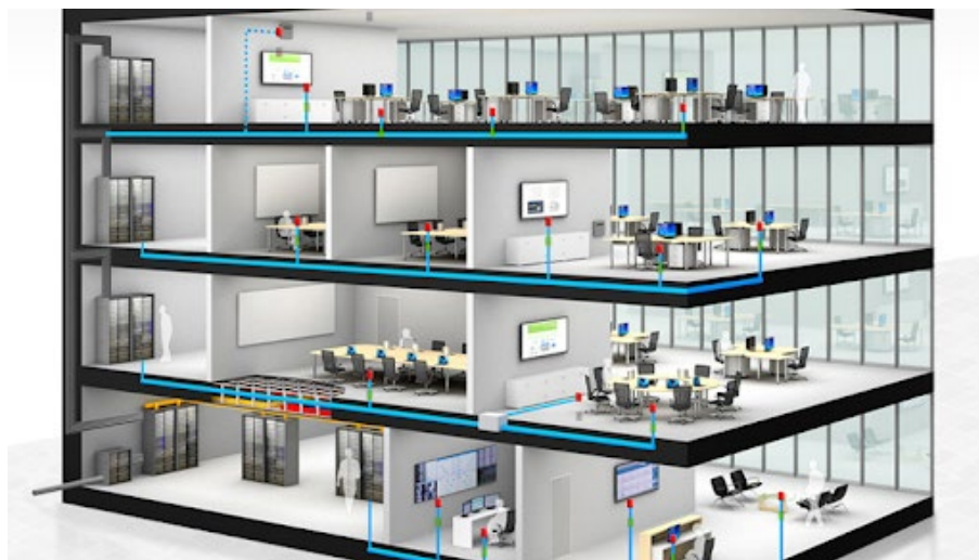
Figura #6. Cableado estructurado con normativa ANSI/TIA/EIA.
