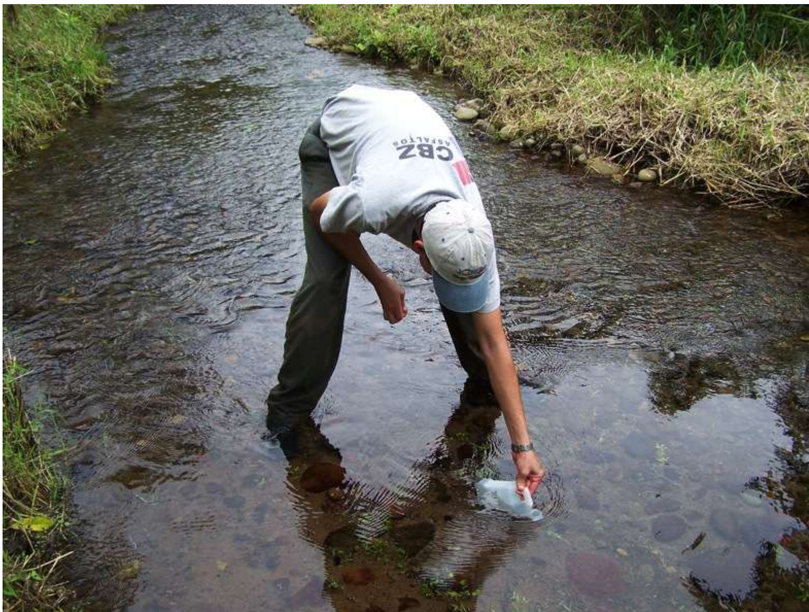
Foto 7. Colecta de muestra de agua en una naciente no captada.
