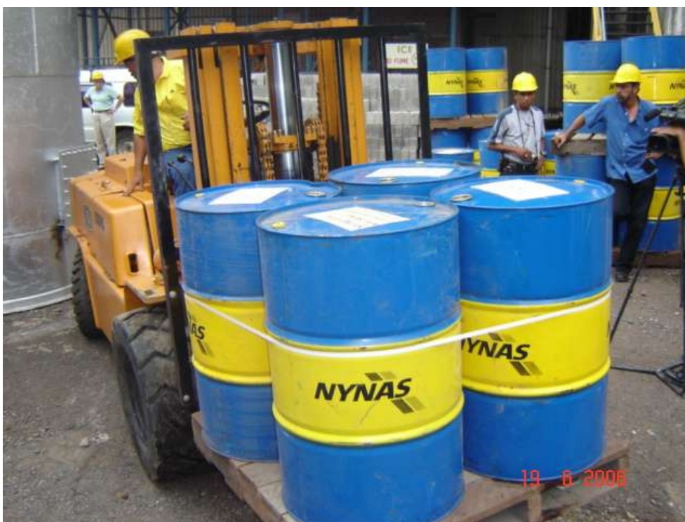
Figura 9 Movilización estañones con aceite Manejo mecanizado de estañones con aceite ICE 2006 Fotografía Ortiz 2006
