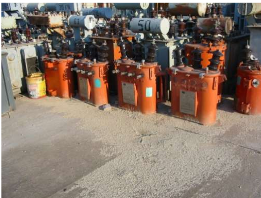
Figura 17 transformadores para desecho sin derrames
