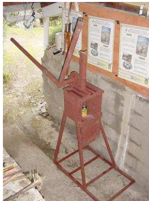
Figura 6. Equipo de compactación manual de desechos sólidos (Fuente: fotografía del autor, marzo 2005)
